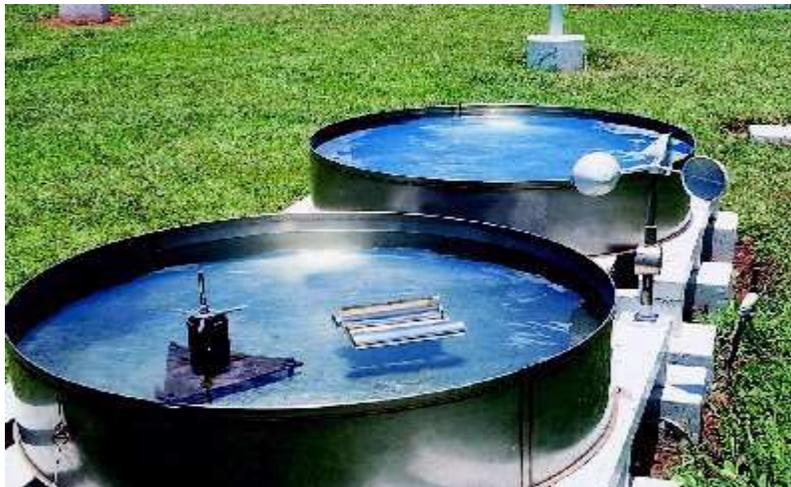
Foto 2.1 Tanque Evaporímetro.
