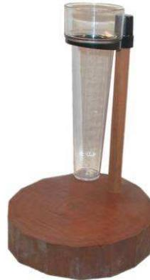
Fig. 2.5 Pluviómetro.
