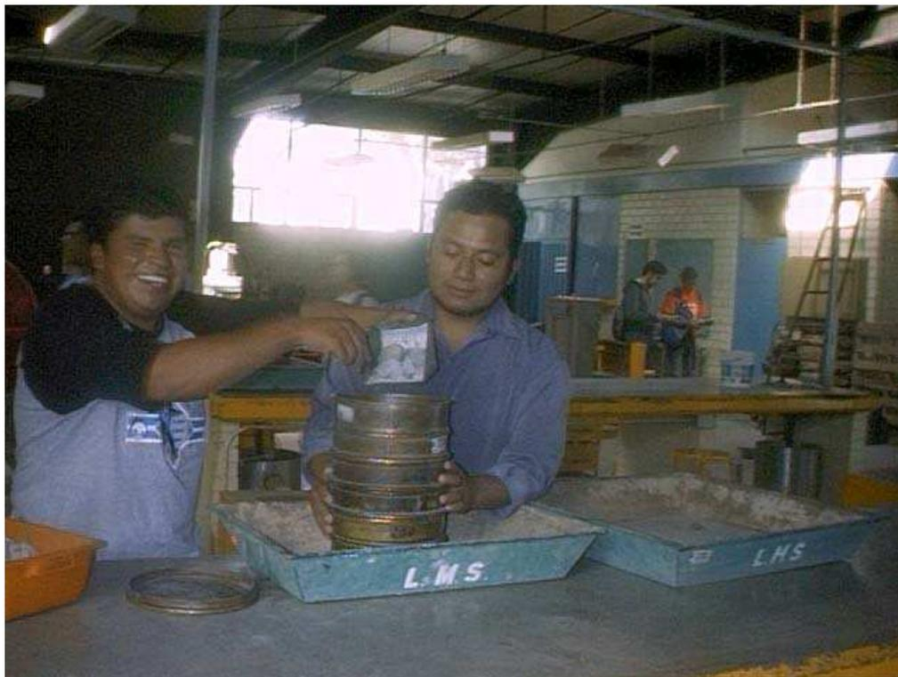
Figura 4.8 Para obtener los límites se utilizaron espátulas, un vidrio, la copa de Casa grande y material cribado por la malla no. 40
